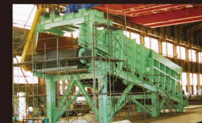
300t / h 3mW×12.8mL ベルトフィーダー
