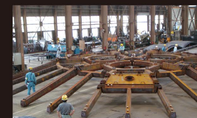
18.3mφ 電気炉炉蓋水冷梁
