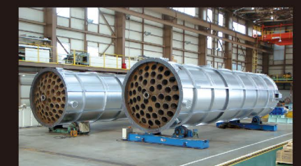
3.25mφ×12.55mL 電気炉集塵機用ガスクーラー
