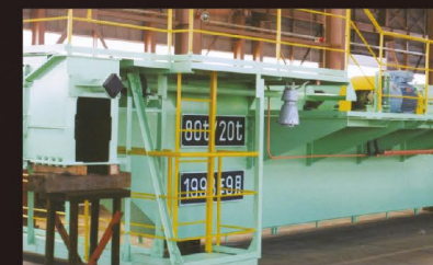
80 / 20t×12.85m クラブトロリー式天井クレーン
