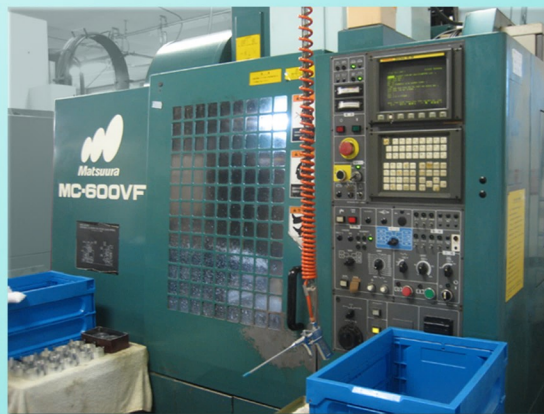
マシニングセンター(松浦機械製作所) チルティング 5軸制御
