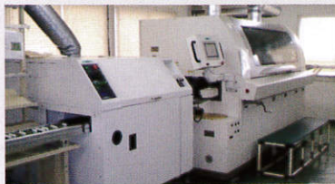
ディスクリート部品実装ライン (鉛フリー専用)
