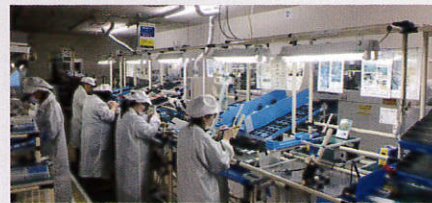
クリーンルームでのモータ搭載型 位置・角度センサ(エンコーダ)製作
