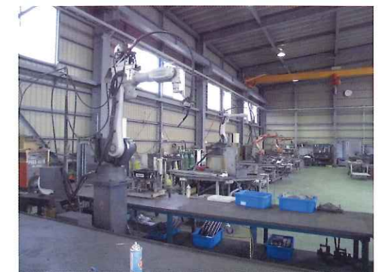
溶接ロボット
