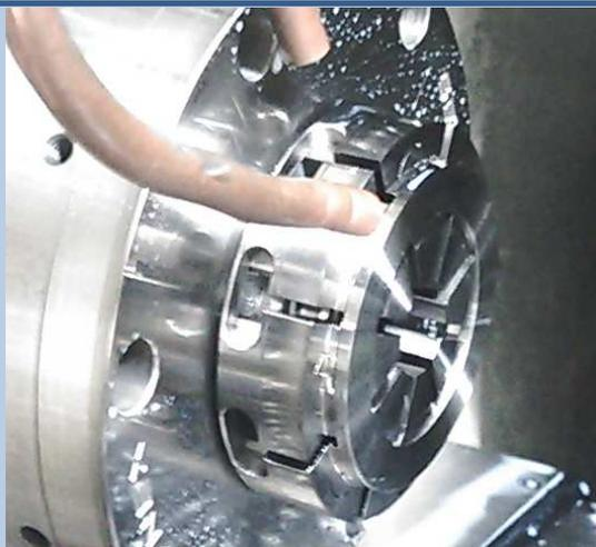
チャッキング方法により、変形する恐れがある製品。
