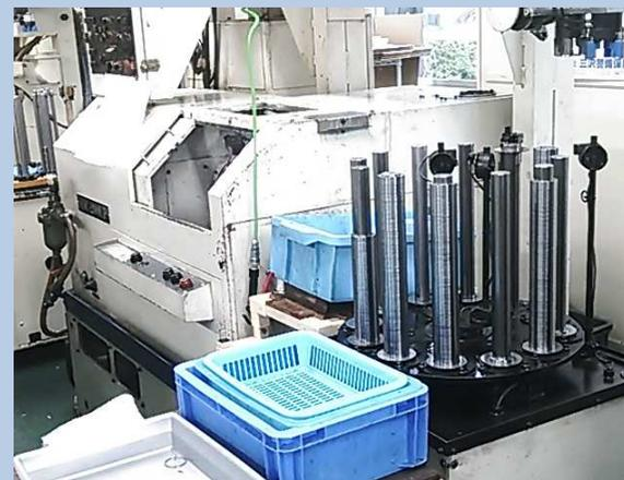
さらに、手付けから、機械を改造してロボット(自動)化を行い、生産数が飛躍的にUP。
