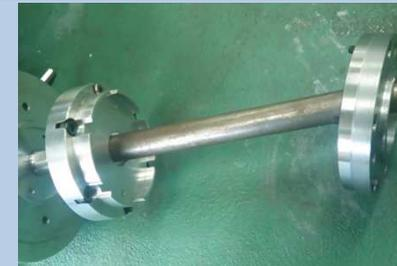
設備毎に、専用のチャックを取りつけて加工するのが、一般的です。
