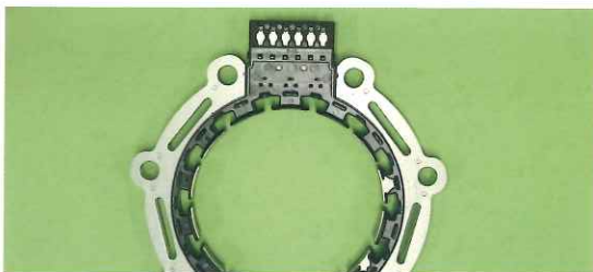
PPS材 コネクタ端子部をインサート及び巻き線部を積層銅板に成形
