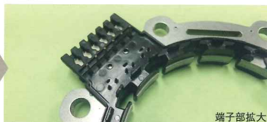
PPS材 コネクタ端子部をインサート及び巻き線部を積層銅板に成形
